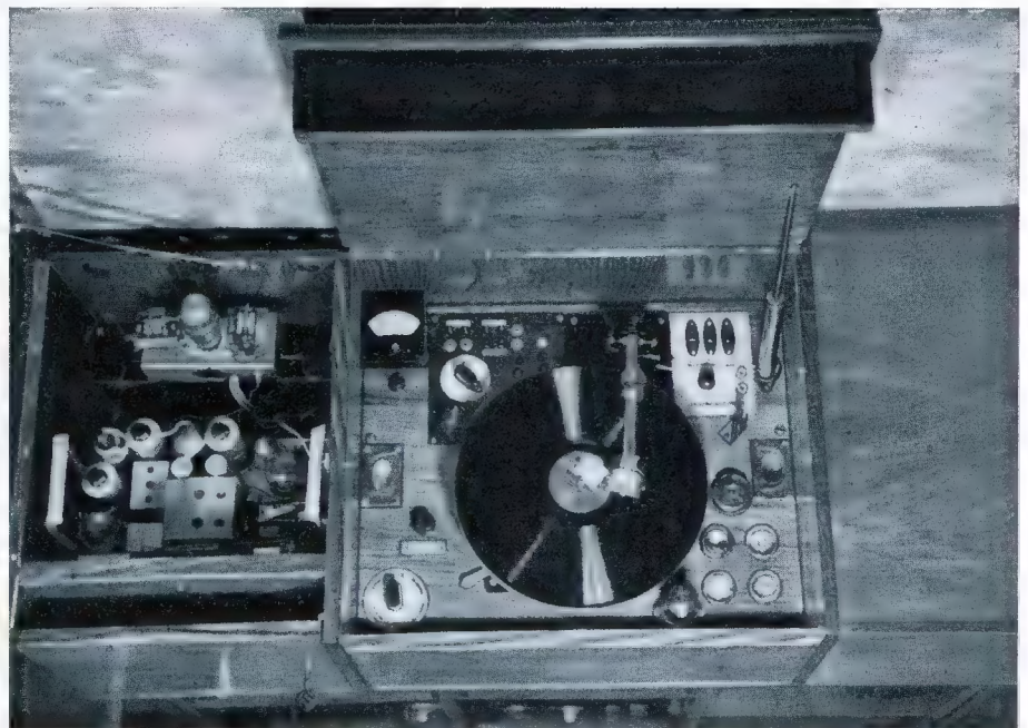
Blick von oben auf den Schallplattenteil. Außer den üblichen Schaltern und Umschaltern für Messungen und Versuche links vorn ein Universalshalter (Nockenshalter), der alle Umschaltungen vereint, welche für den Nur-Hörer in Frage kommen. Die Welle dieses Schalters ist 95 cm lang (!), wird zweimal im rechten Winkel geführt und ist teilweise sogar abgeschirmt. Der Schalter funktioniert — allen vorher geübten Bedenken zum Trotz — sehr gut! Der Deckel über dem Empfängerteil ist hochgeklappt, damit der hinter dem Superhet stehende Ortsfender-Empfangsvoratz zu sehen ist.
